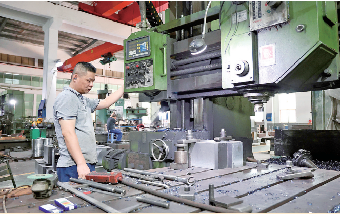
图为龙门铣床在加工轧机的轴承座。全媒体记者 杨洲 摄
