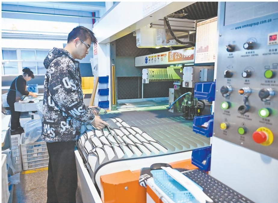
图为工人在智能化切割机前,取出裁断好的鞋面。全媒体记者 林罗晓 摄
